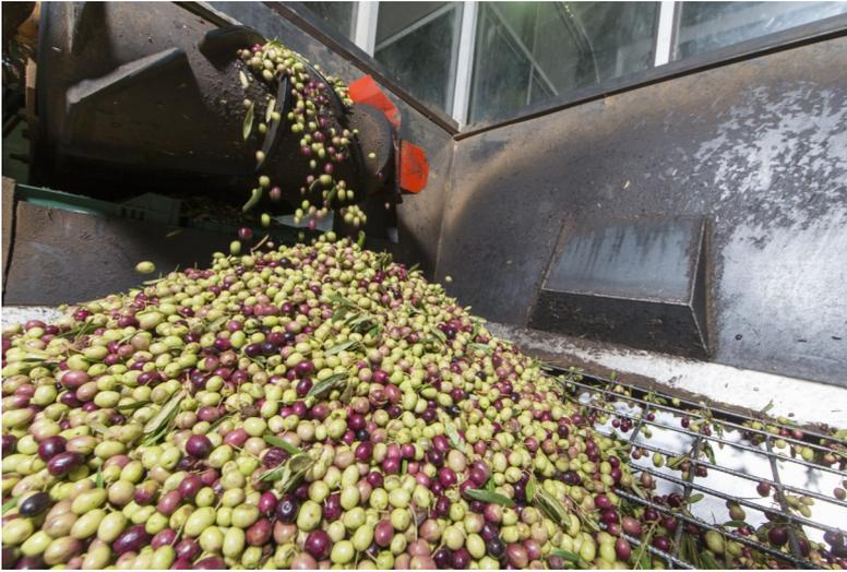
بعد قطف الزيتون وجمعه ، تبدأ مراحل عصر الزيتون بفرز الزيتون من بقايا الأشجار كالورق والأعواد ، ثم يمر الزيتون بمرحلة غسل الثمرة ، ثم يتم نقلها أوتوماتيكياً للمرور بمرحلة الطحن ، ثم تتم عملية تصفية الزيت من بقايا الزيتون ، وهو ما يسمى "الجفت" ، ثم تتم عملية غسل "الزيت" من الشوائب بعد استخراجه، بعدها تتم تعبئته في جوانات خاصة.
